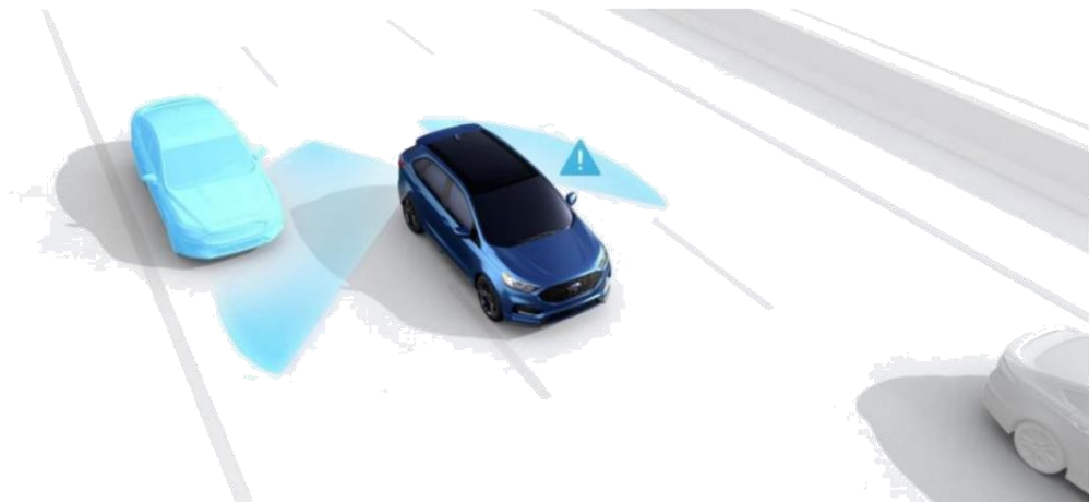
Рис. 3.12 - Радіус дії датчиків система BLIS від FORD
