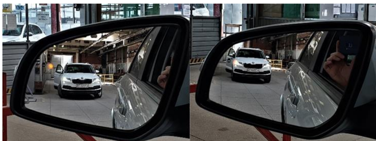
Рис. 3.3 - Перекриття індикатора сліпих зон світлом фар
