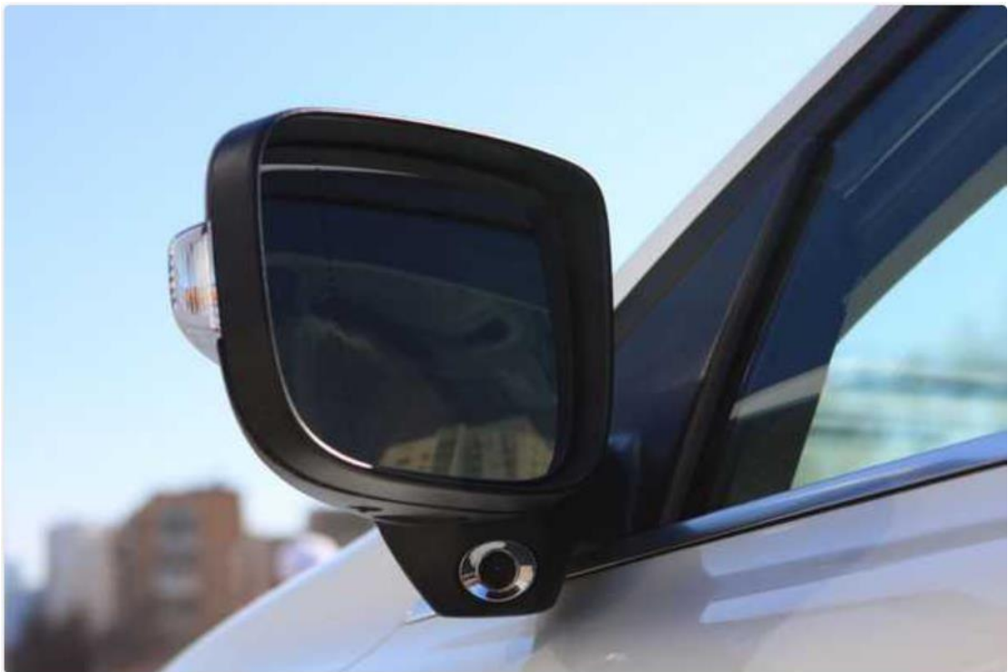
Рис. 3.10 - Дзеркало заднього виду із сенсором сліпої зони у вигляді камери
