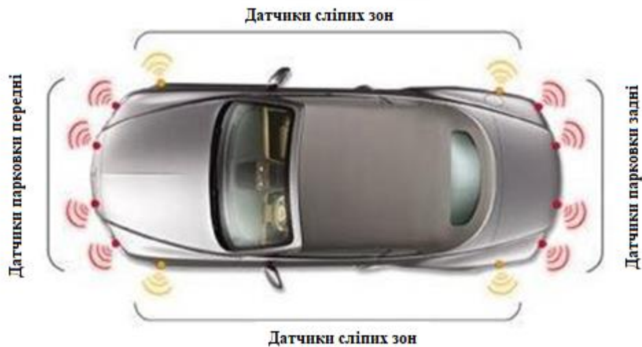
Рис. 3.9 - Розташування сенсорів у вигляді радарів на автомобілі
