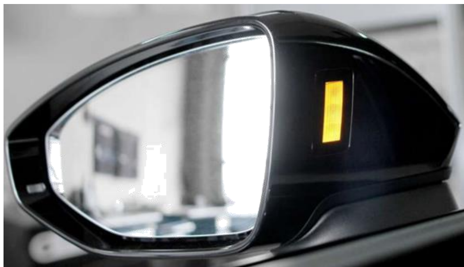
Рис. 3.7 - Приклад застосування індикатора винесеного на внутрішню стінку дзеркала в автомобілях AUDI
