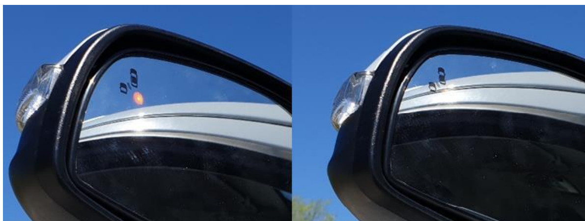
Рис. 3.1 - Перекриття сонячними відблисками індикатора сліпих зон
