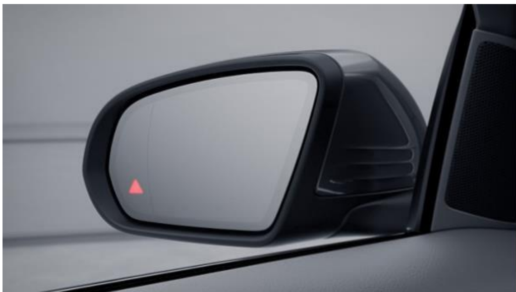
Рис. 3.5 - Приклад застосування індикатора червоного кольору в автомобілях Mercedes-Benz
