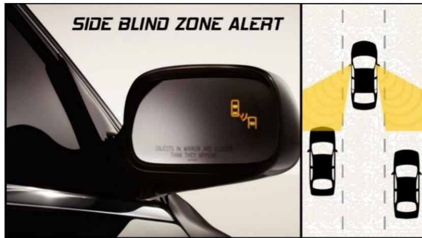
Рис. 3.14 - Радіус дії датчиків Side Blind zone alert
