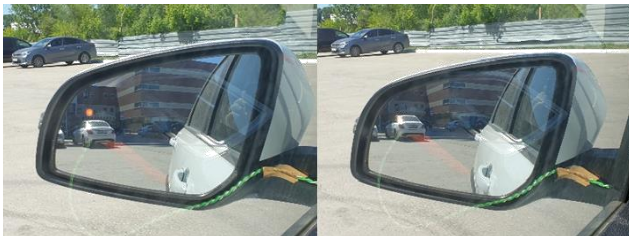
Рис. 3.2 - Вигляд відблисків із салону автомобіля
