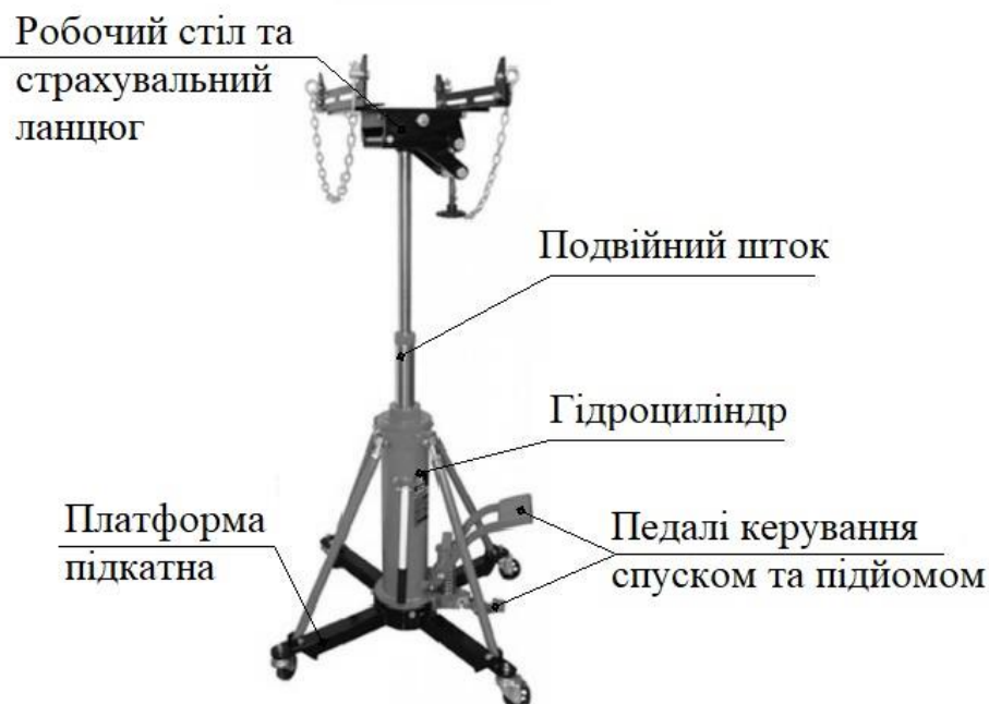
Рис. 2.4. – Опис конструктивних елементів на зображенні технологічного обладнання WDK-80591 Wiederkraft
