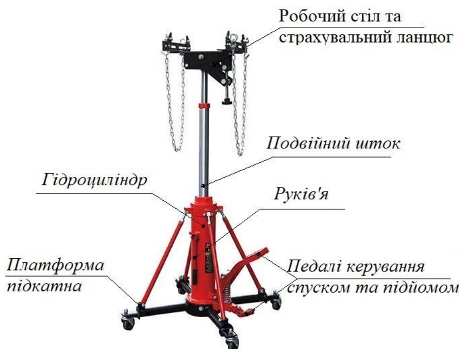
Рис. 2.6. – Опис конструктивних елементів на зображенні технологічного обладнання TL0806
