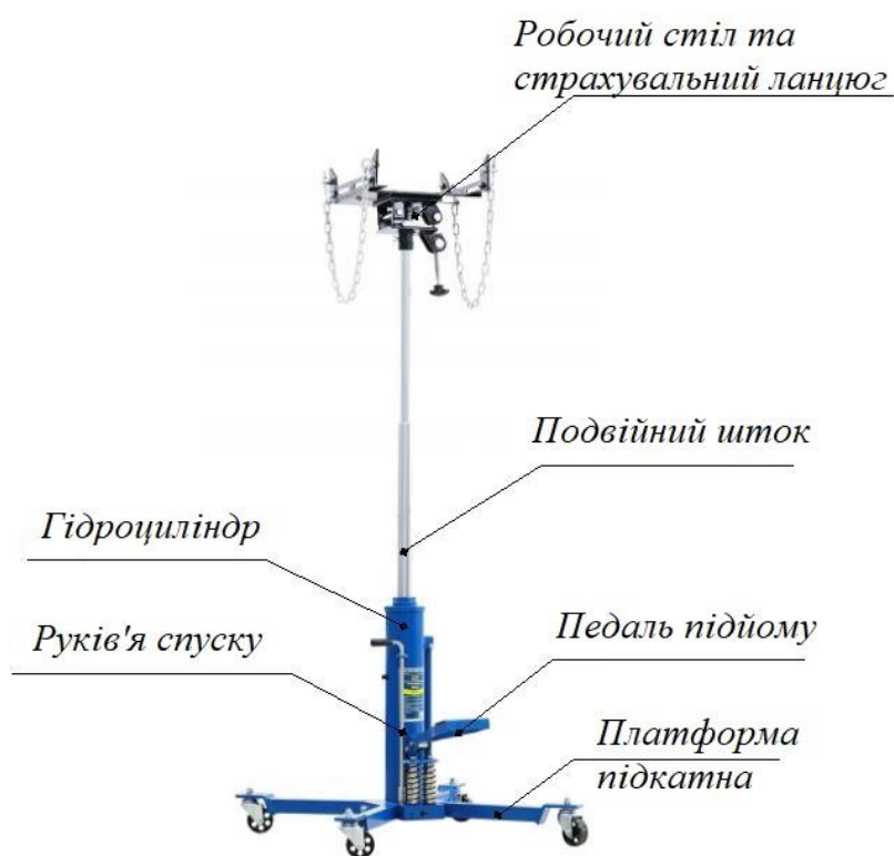
Рис. 2.7. – Опис конструктивних елементів на зображенні технологічного обладнання Nordberg N3407
