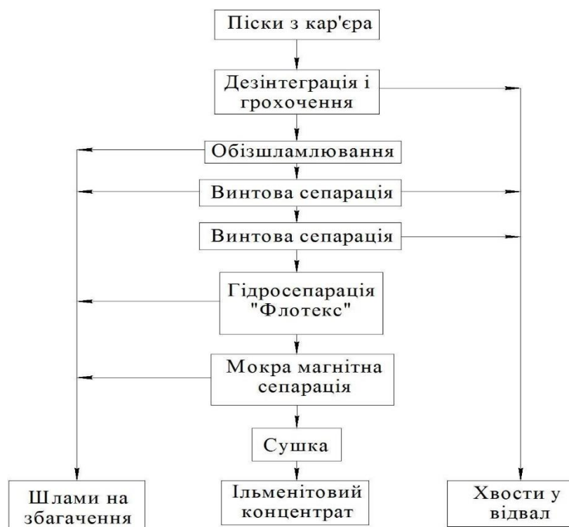
Рис.1 Принципова схема збагачення титан-цирконієвих пісків Іршанського ГЗК
