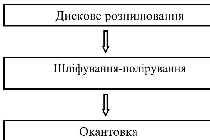
Рис.2.1 Технологічна схема обробки високоміцного каменю
