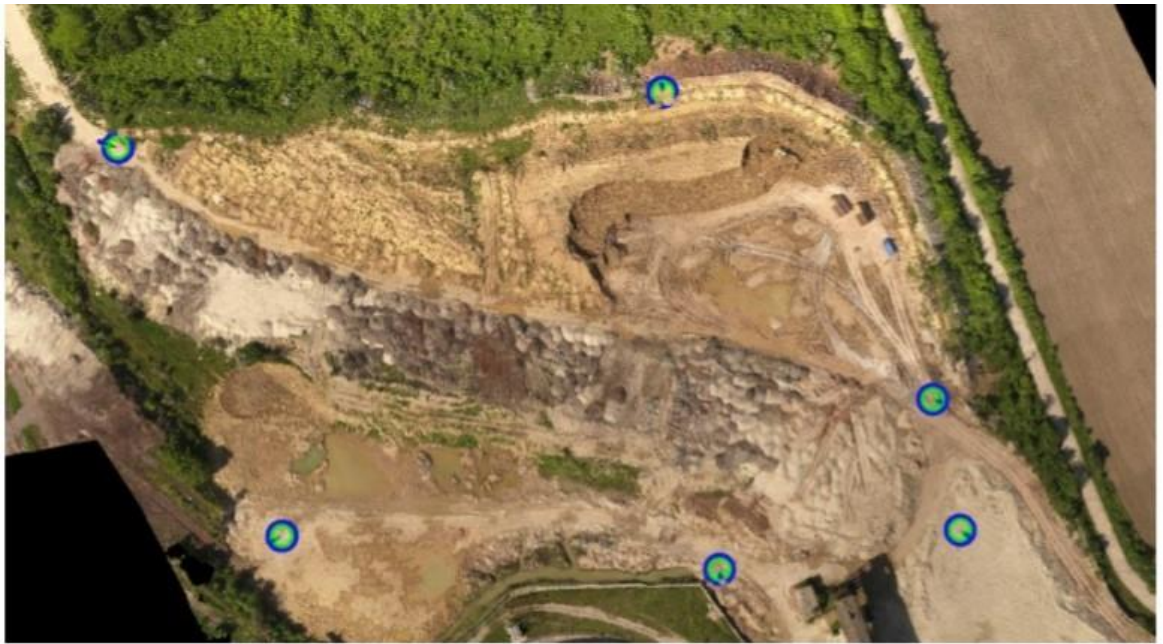
Рис. 4.1. Опорні точки для визначення об'ємів насипу вапняку.
