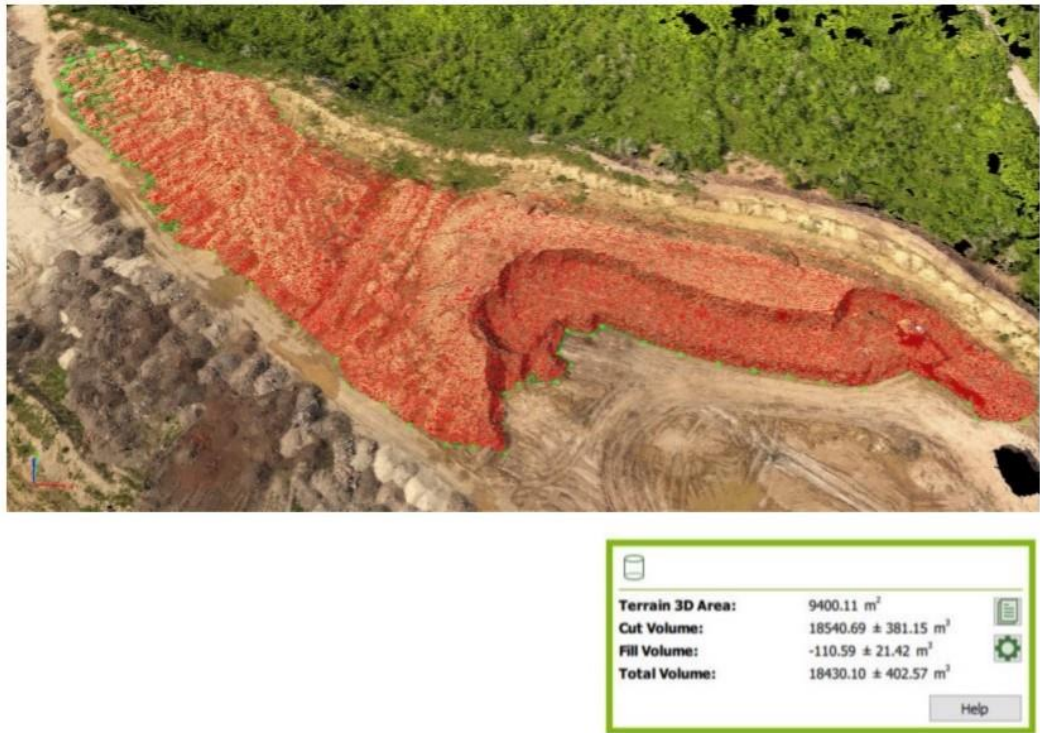
Рис. 4.3. Процес обрахунку обсягу насипу на основі ЦММ.
