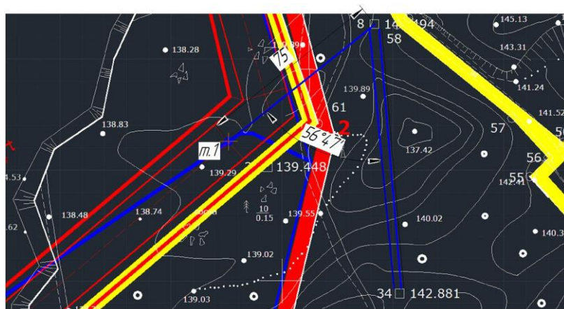
Рис. 4.6. Елементи виносу в натуру осі траншеї
