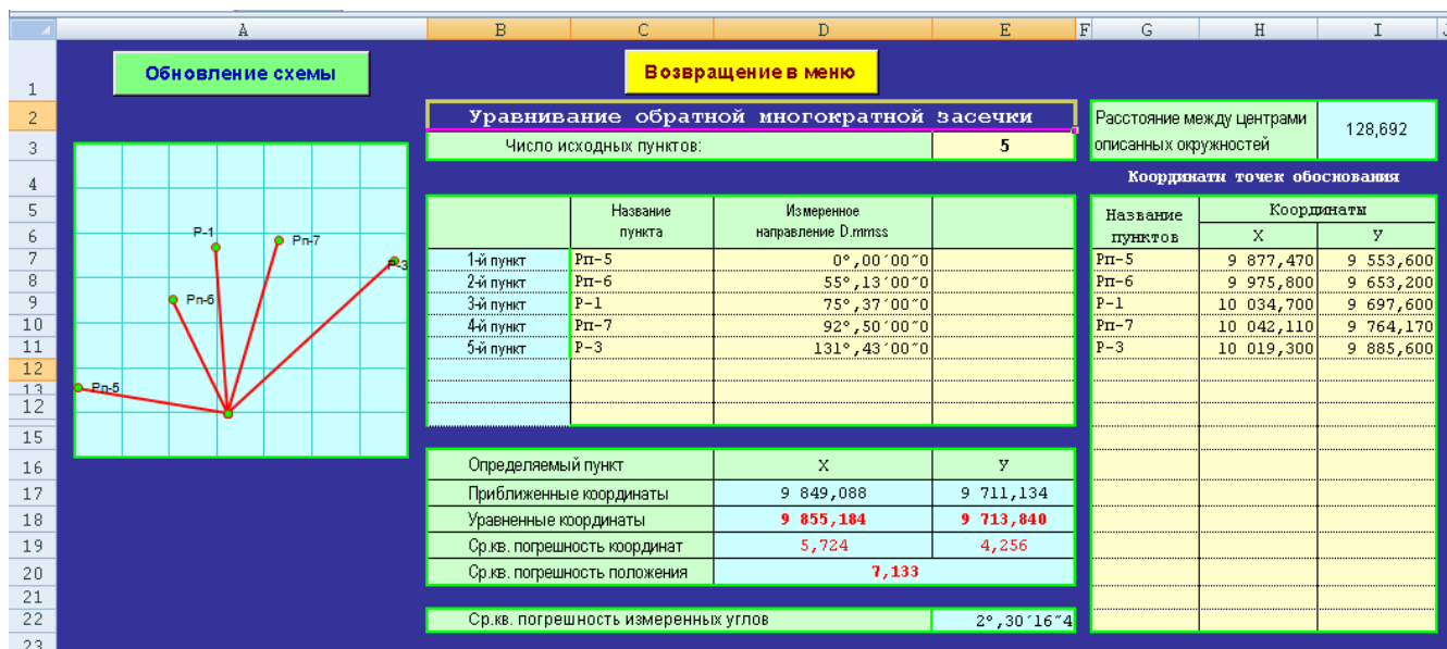
Рис.4.2. Розрахунок оберненої засічки виконується за допомогою програмного забезпечення «Геодезичний калькулятор»
