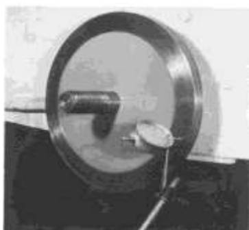
Рис. 2.5 Схема установки индикатора часового типа на валу дисковой пилки, для проверки торцевого биття вала
