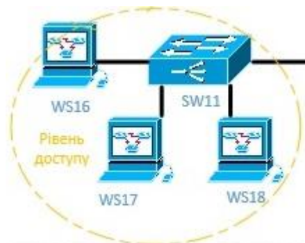
Рис 2.10. Під'єднані пристрої до комутатора SW11
