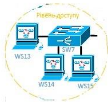
Рис 2.8. Під'єднані пристрої до комутатора SW7
