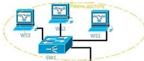
Рис 2.4. Під'єднані пристрої до комутатора SW1
