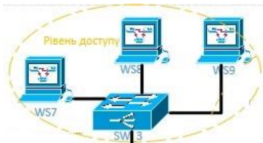
Рис 2.6. Під'єднані пристрої до комутатора SW3
