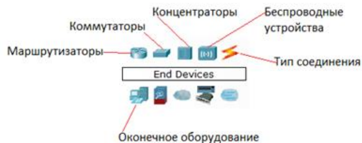
Рисунок 1.5 - Панель обладнання Packet Tracer (Основні типи обладнання)
