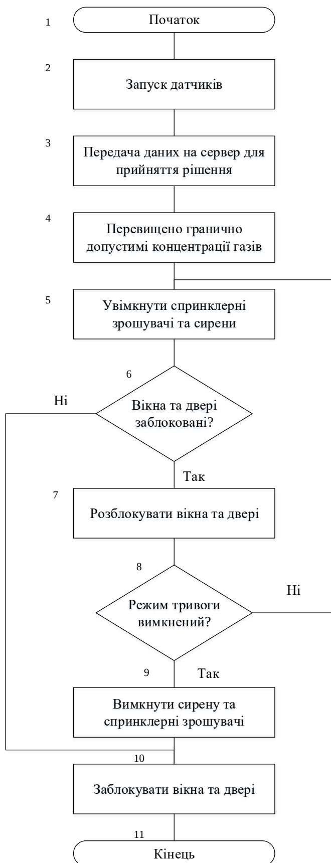
Рисунок 2.3 – Алгоритм функціонування протипожежної системи
