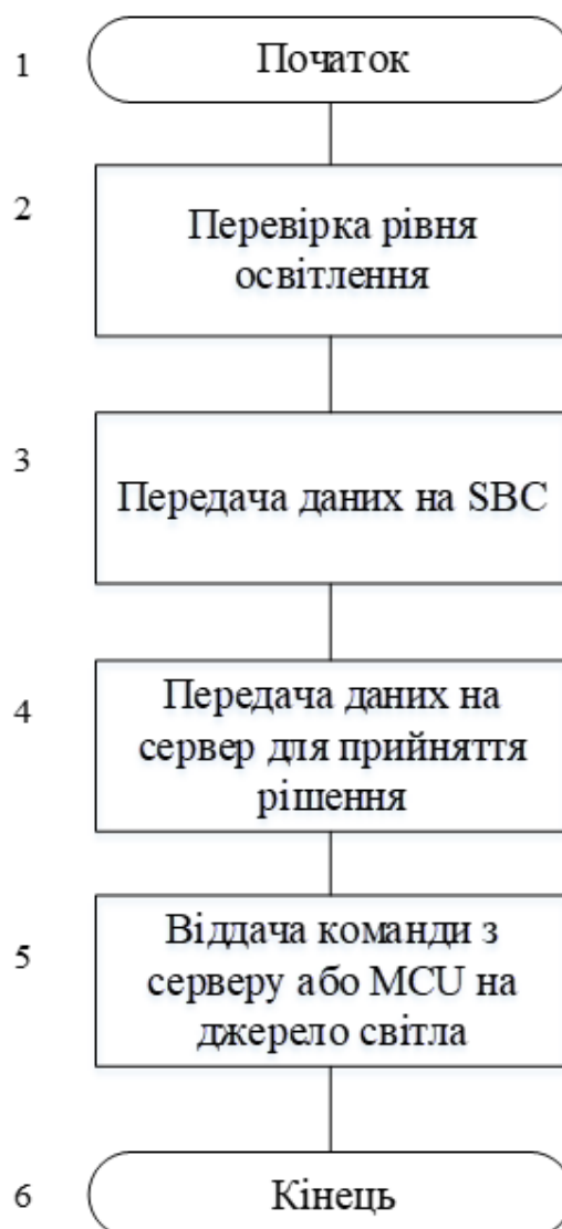
Рисунок 2.5 – Загальний алгоритм роботи системи освітлення
