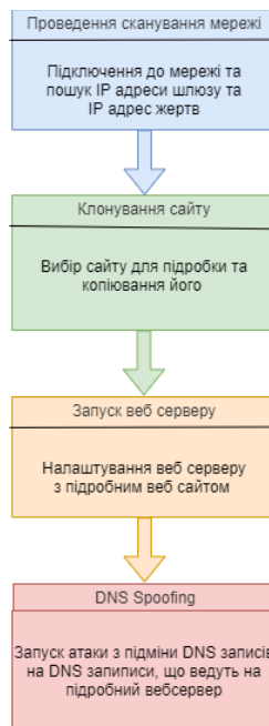
Рисунок 1.34 – Схема виконання атаки на DNS
