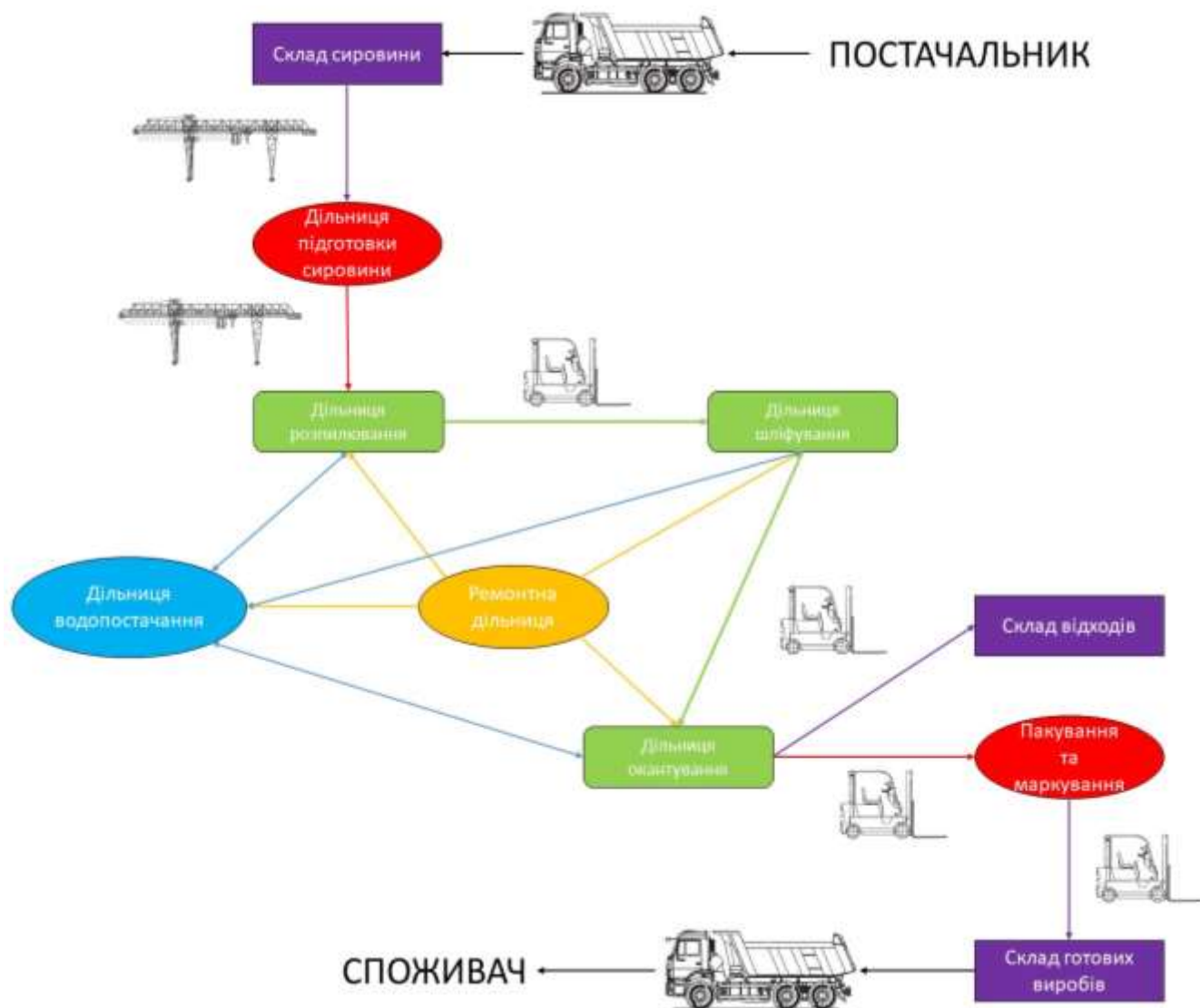
Рис.2.1. Технологічна схема обробки природного каменю за умов ПП «Губернатор»
