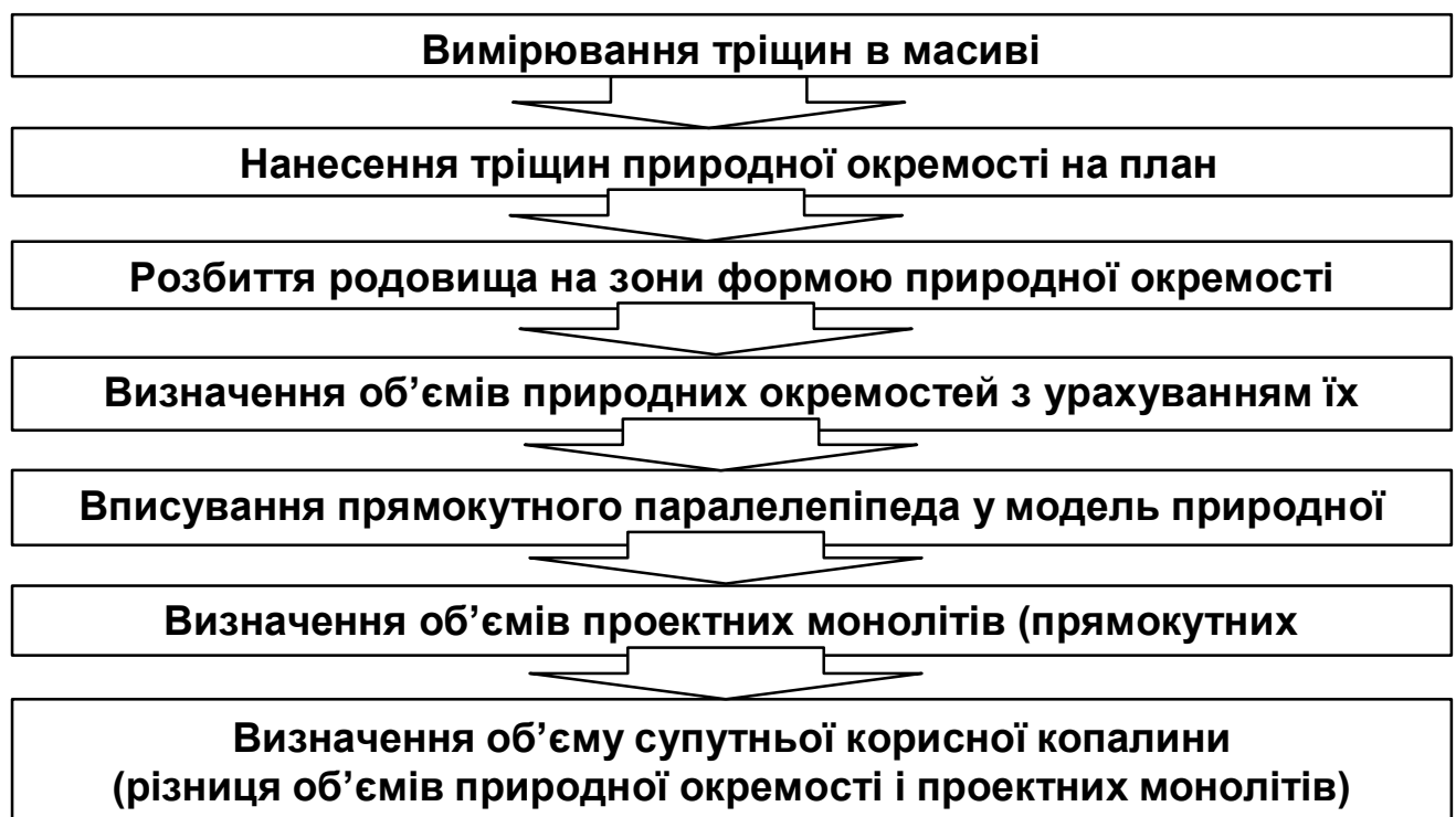
Рис. 4.4. Алгоритм визначення об'єму супутньої корисної копалини для умов ПМП «Граніт»
