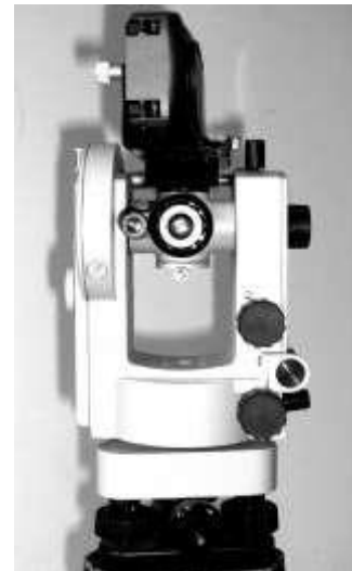
Рис. 4.8 Віддалемір в кріпленні на теодоліт 4Т 30П:
