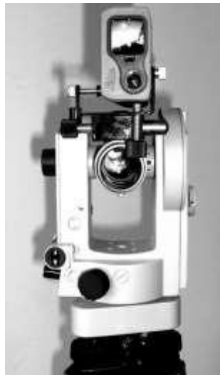
Рис. 4.8 Віддалемір в кріпленні на теодоліт 4Т 30П:
