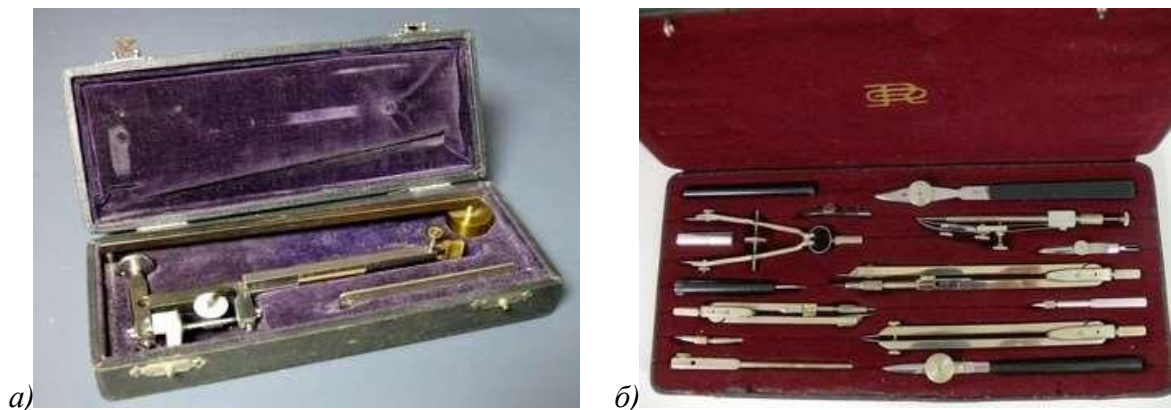
Рис. 4.2. Креслярське приладдя: а) планіметр; б) готвальня.
