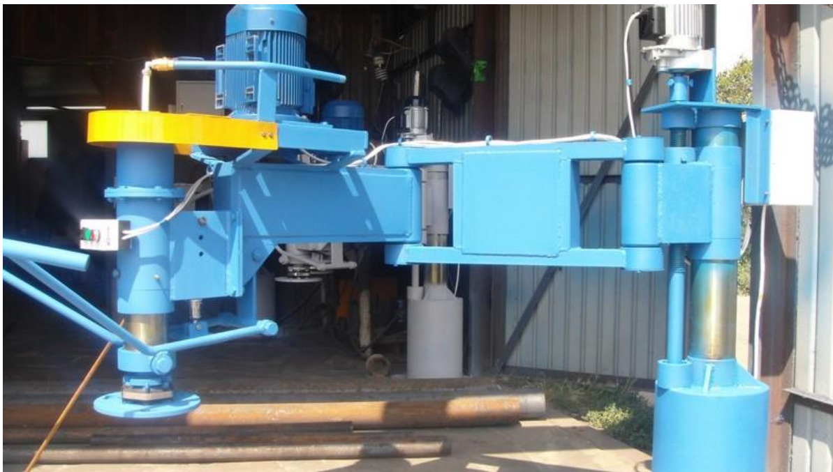
Рис. 2.2. Радіально-консольний шліфувально-полірувальний верстат WQB-5
