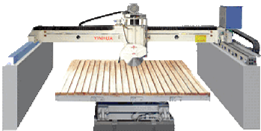
Рис. 2.3. Окантувальний верстат QHW-350/400
