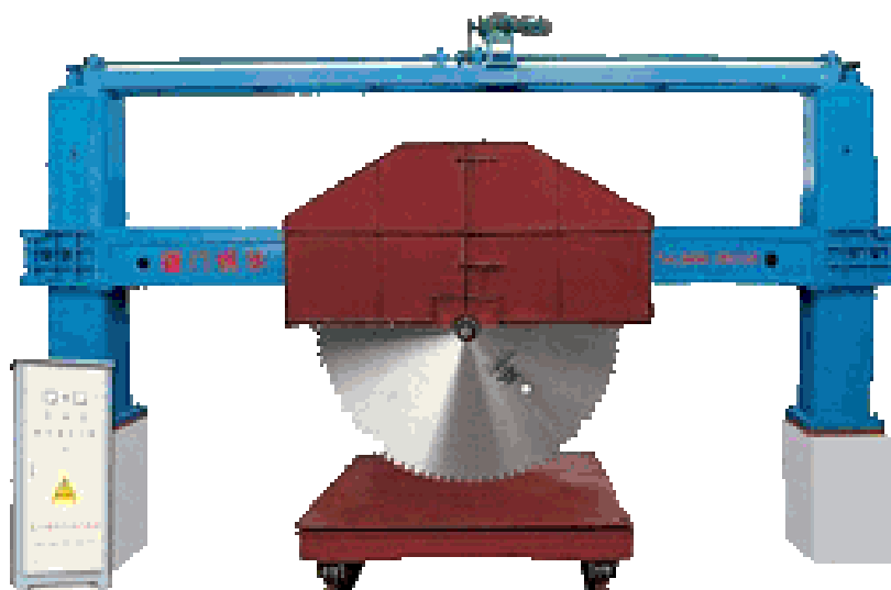
Рис.2.1. LMQ-220B автоматичний розпилювальний верстат портального типу
