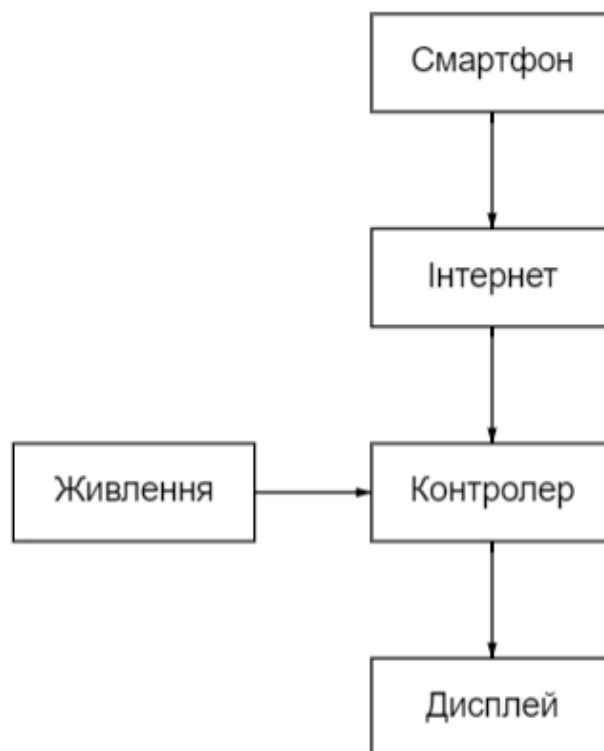
Рисунок 2.0 – Структурна схема системи управління рюкзака з дисплеєм
