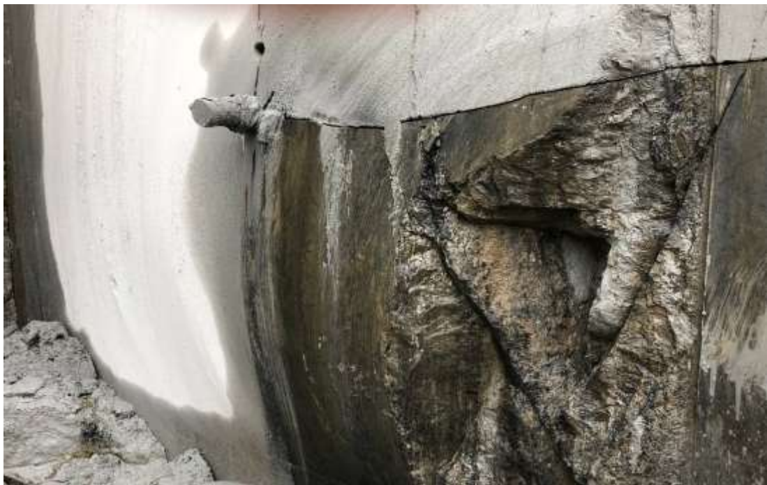
Рис. 3. Викривлення поверхні блоку при розпилюванні зношеним канатом на Невирівському родовищі лабрадориту
