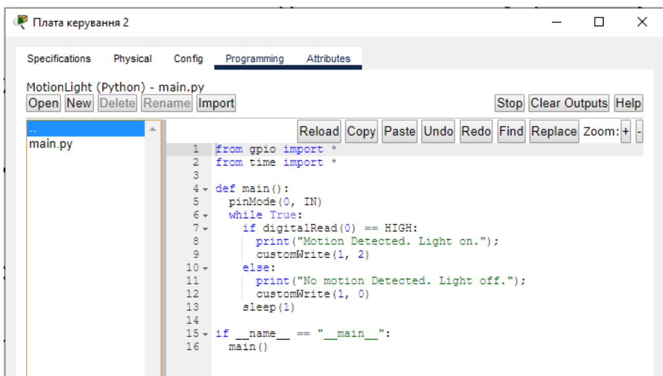
Рисунок 3.10 – Створений проект для взаємодії з датчиком руху та прописаний код
