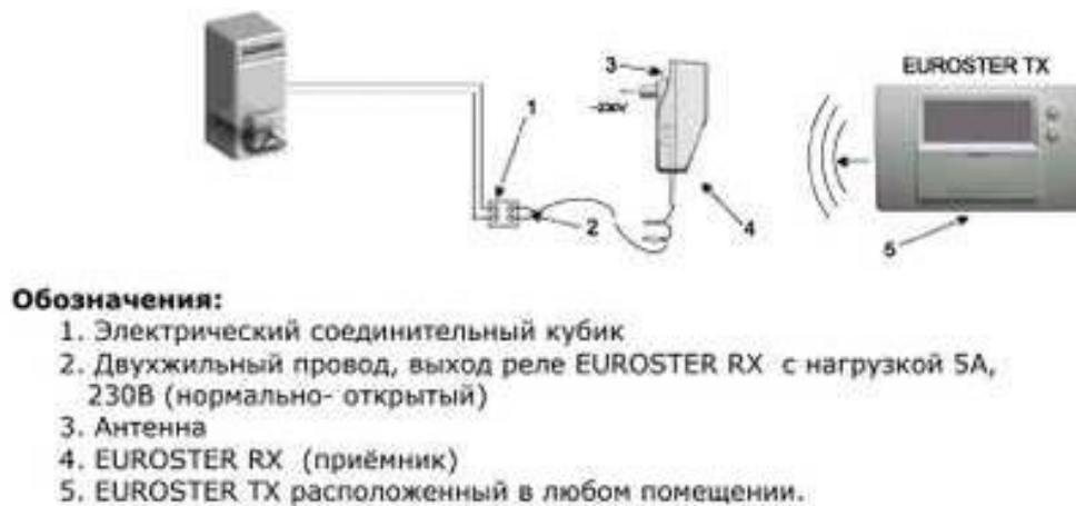
Рисунок 1.4 – Схема підключення терморегулятора Euroster 2006 TX до газового котла
