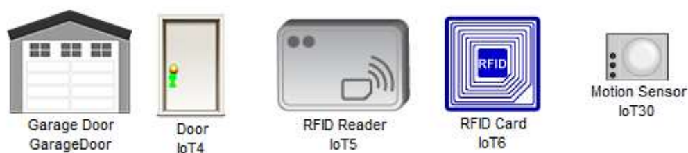
Рисунок 2.2 – Елементи вузлу системи контролю доступу та ідентифікації робітників
