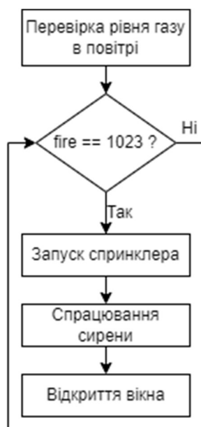
Рисунок 2.14 – Цикл перевірки вмісту газу в повітрі датчиком Програмно цикл виглядатиме наступним чином:
