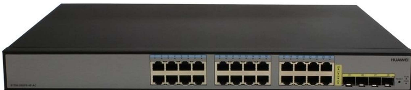
Рисунок 3.6 – Комутатор Huawei S1700-28GFR-4P-AC
