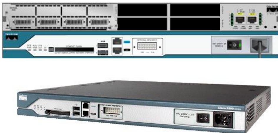
Рис 3.4 Cisco 2811 (схематичне зображення у PacketTracer та реальний вигляд)
