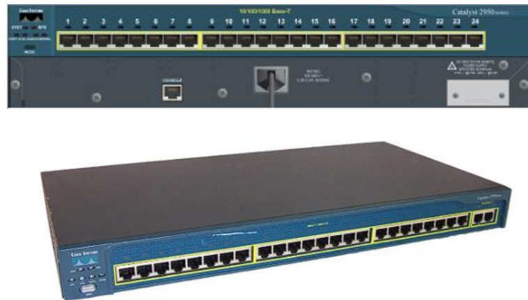
Рис 3.2 Cisco 2950-24 (схематичне зображення у PacketTracer та реальний вигляд)
