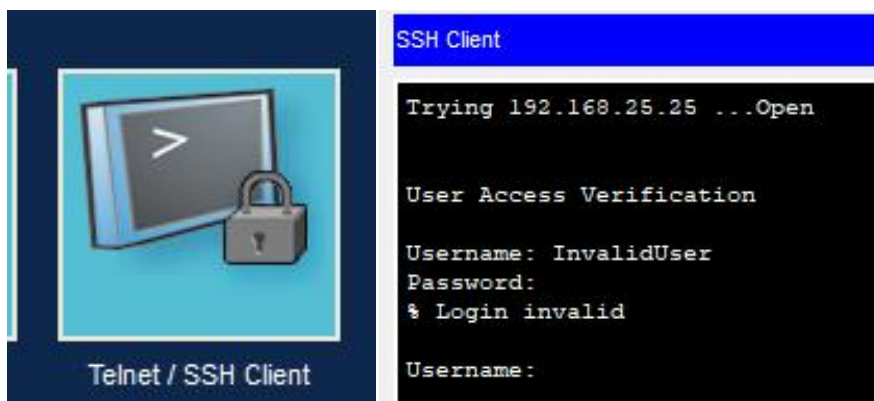
Рис 3.20 Помилки віддаленого підключення
