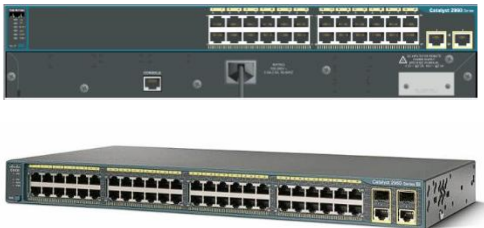
Рис 3.1 Cisco 2960 IOS15 (схематичне зображення у PacketTracer та реальний вигляд)
