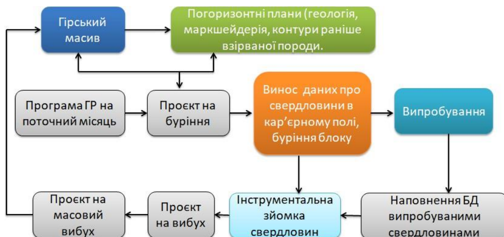
Рисунок 4.2. - Схема взаємодії інженерних служб у процесі проектування та ведення БВР для гірських підприємств з відкритим способом видобутку корисних копалин
