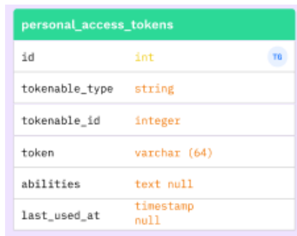
Рисунок 2.3.6 - Фрагмент діаграми сутність-зв’язок БД, що відповідає за API токени
