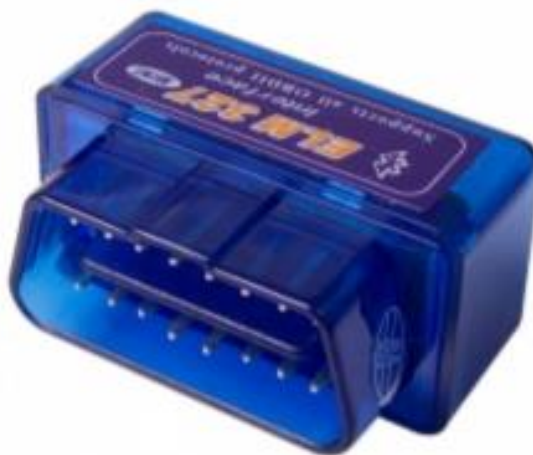
Рис.2.3. Діагностичний пристрій ELM327
