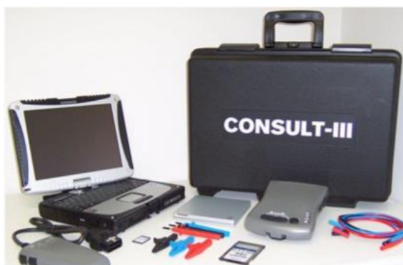
Рис.2.1. Діагностичний пристрій Nissan Consult-3 Plus
