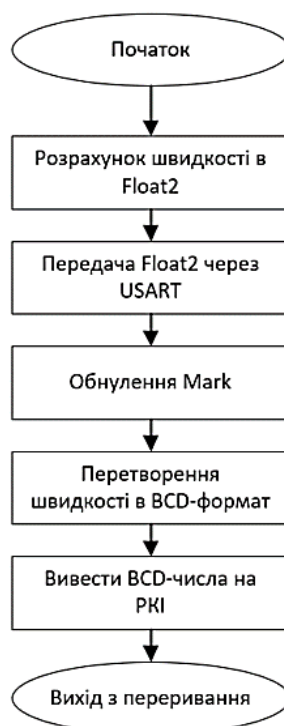
Рис. 6.4. Блок-схема алгоритму обробки переривань таймеру
