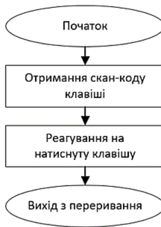
Рис. 6.3. Блок-схема алгоритму обробки переривань INT0
