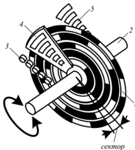
Рис. 2.5. Конструкція обертального абсолютного енкодера
