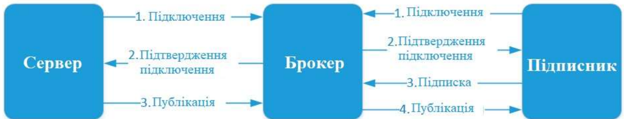
Рисунок 1.9 — Схема взаємодії пристроїв та сервера за допомогою брокера.
