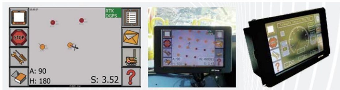
Рис.4.1 (інтелектуальна панель навігаційного GPS обладнання)
