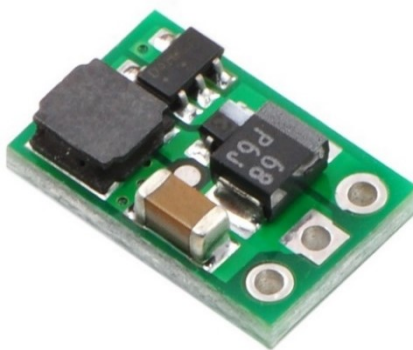
Рисунок 4.6 – Вигляд підвищуючого перетворювача
