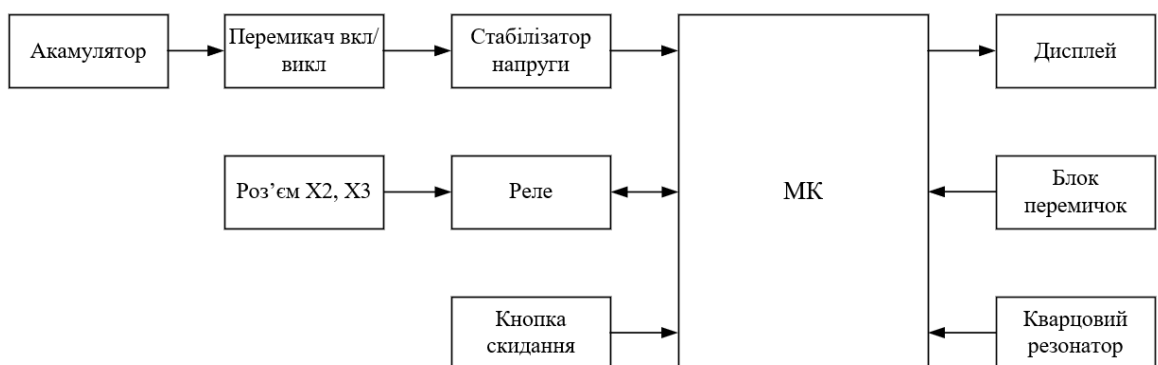
Рисунок 3.1 – Структурна схема комп'ютеризованої системи вимірювання та контролю ємності та індуктивності компонентів електронних схем
