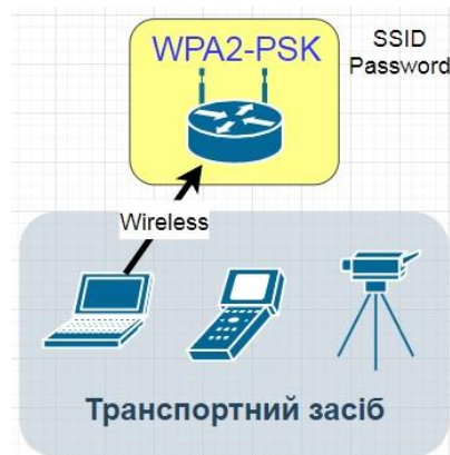
Рис. 2.4 – Автентифікація нового пристрою з використанням функції доступу за паролем
