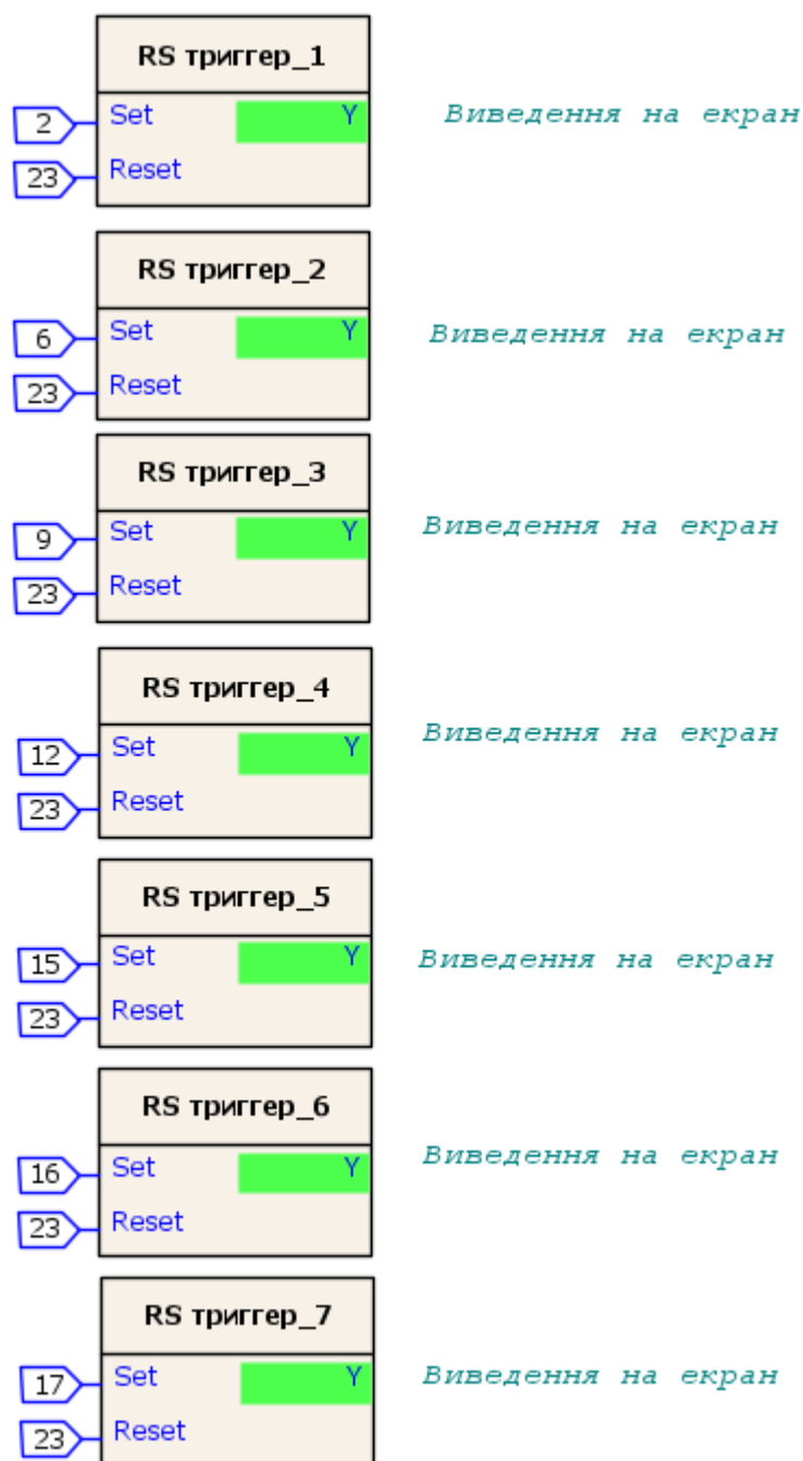
Рисунок 3.8 – Затримка сигналу тривоги по приміщенням
