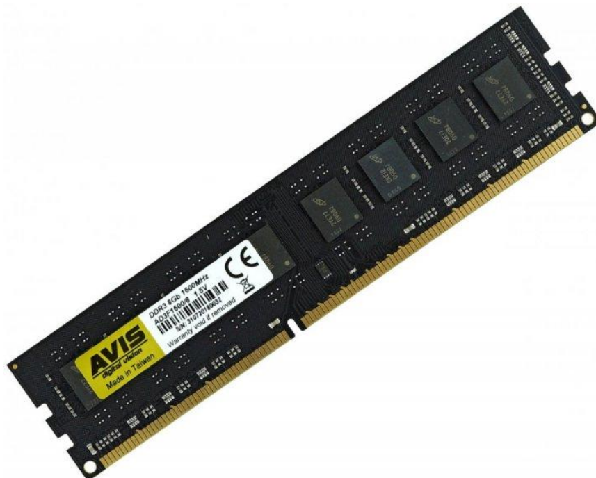
Рисунок 3.6 – Модуль оперативної пам'яті DDR3 на 4 Гігабайт
