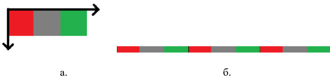
Рисунок 2.1 - а) Розширення координат; б) Розширена вісь x після розділення значення RGB за шириною
