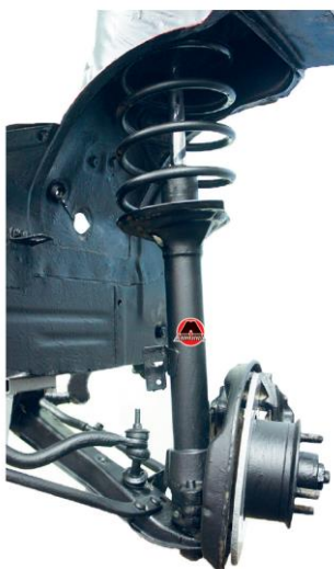
Рис.1.5. Підвіска зі стійкою Макферсона
