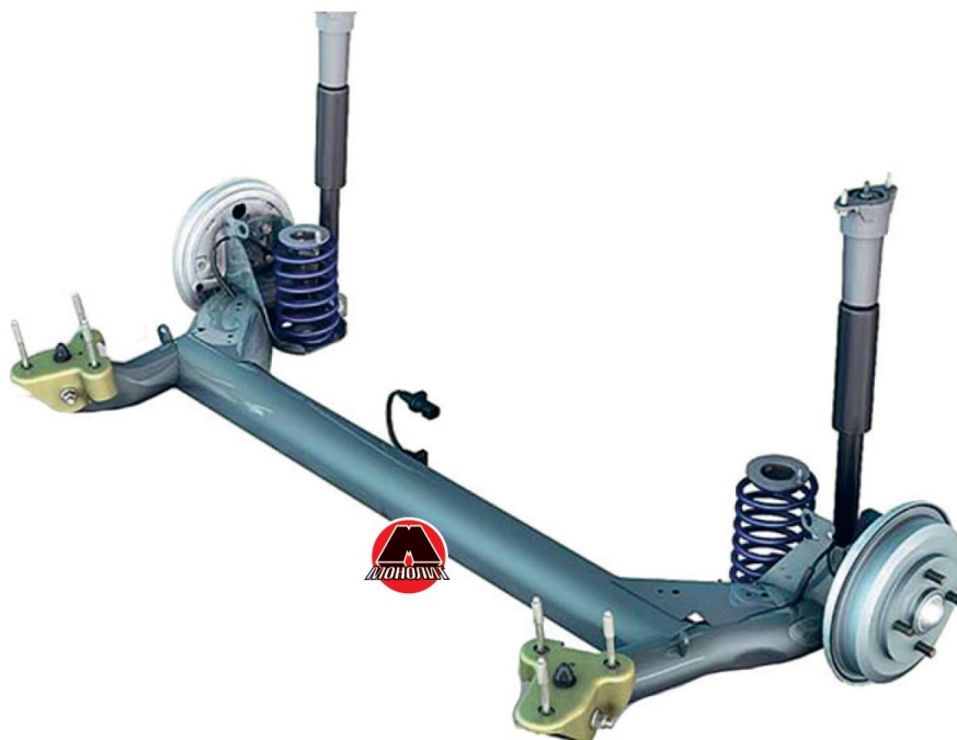
Рис.1.8. Приклад задньої напівзалежної підвіски
