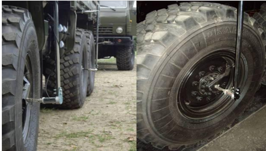
Рис. 3.9. Встановлення торцевих струмознімачів на автомобілі
