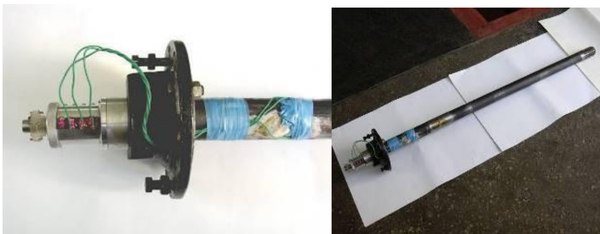
Рис. 3.6. Установка тензометричних датчиків на піввісь автомобіля
