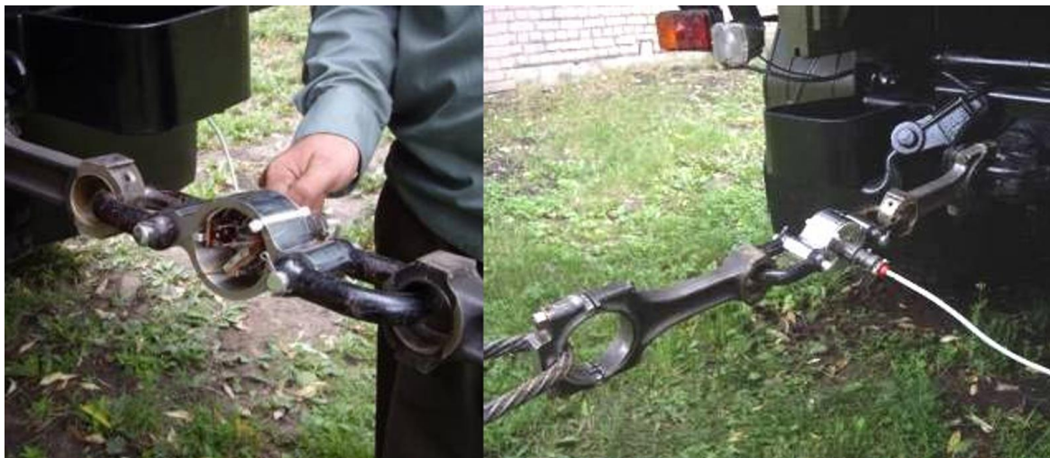
Рис. 3.8. Встановлення тягової тензометричної ланки на автомобілі
