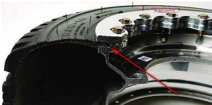
Рис. 4.2. Захисний засіб проти саморозбирання колеса
