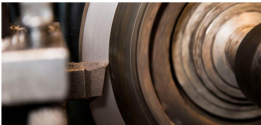
Рис.3.2. Проточування гальмівного диска
