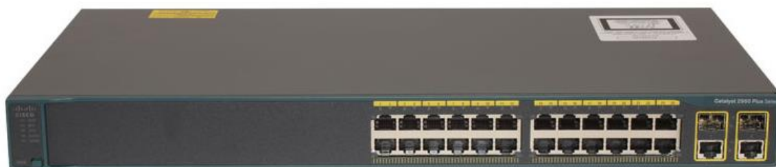
Рисунок 2.5 – Комутатор Cisco WS-C2960+24TC-L
