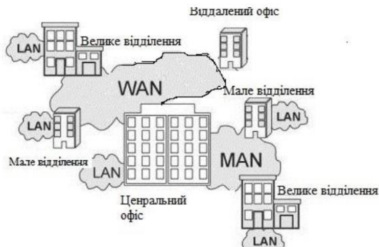
Рисунок 1.1 – Узагальнена схема корпоративної мережі
