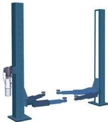
Рис. 2.2 – Двохстієчний електрогідравлічний підйомник П191
