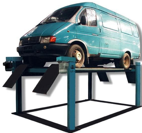
Рис. 2.3 – Чотиристієчний підйомник П181.01
