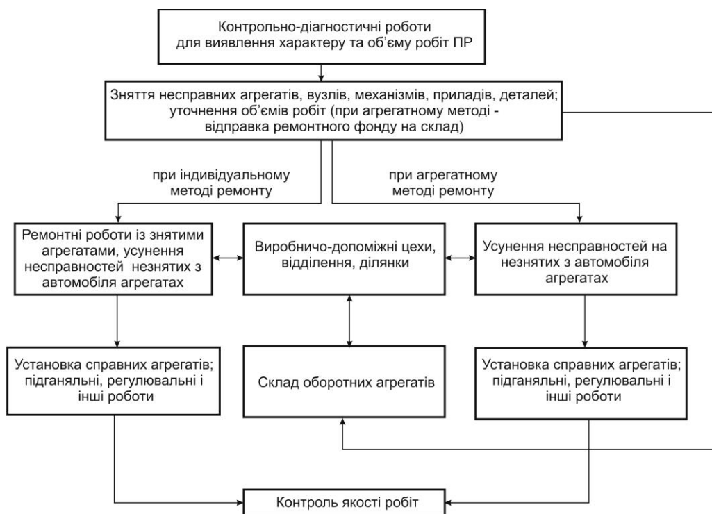
Рис. 1.1. - Схема процесу ПР автомобілів
