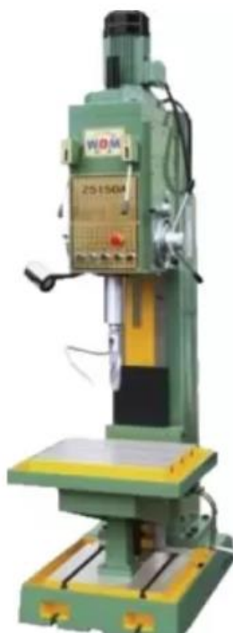
Рис.2.9. - Вертикально-свердильний станок Z5163B
