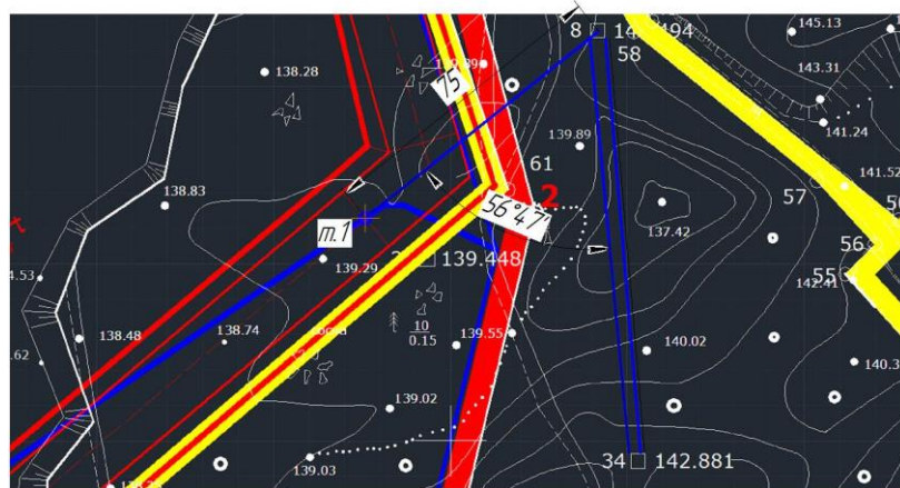
Рис. 4.4. Приклад виносу в натуру елементів осі траншеї
