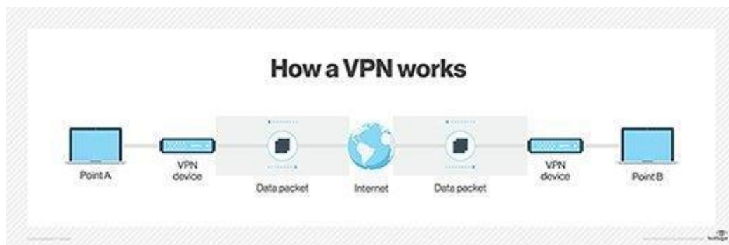
Рисунок 1.6 – Робота технології VPN
