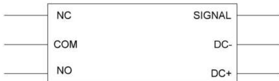
Рисунок 14 - Схема підключення реле FL-3FF-S-Z
