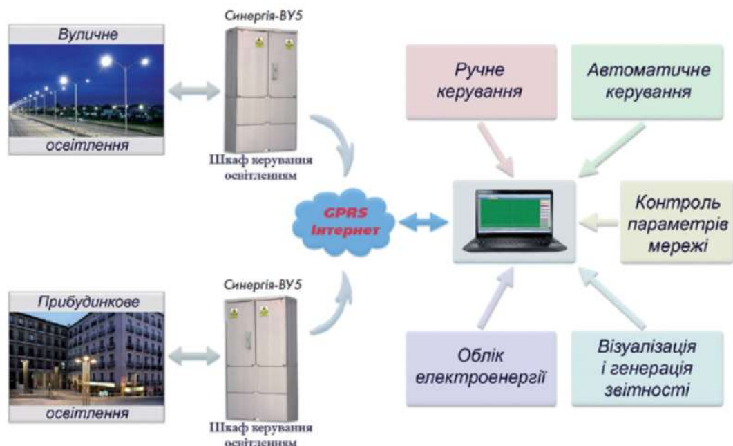
Рисунок 2 – Система GSM-диспетчеризації освітлення
