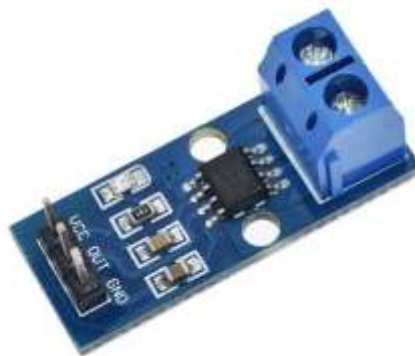
Рисунок 17 – модуль датчика струму ACS712
