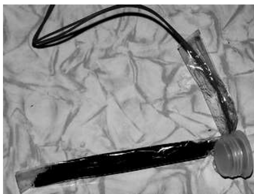
Рис. 2.3. Пускач електричний з пластиковою пробкою
