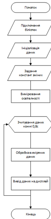
Рис. 5.1 Блок-схема алгоритму роботи програми
