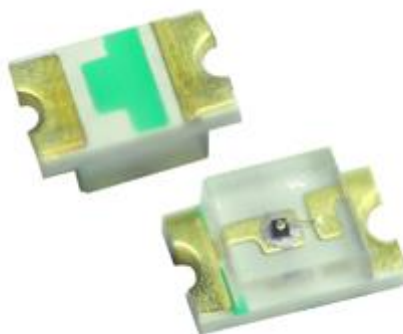
Рис.4.11.Зовнішній вигляд червоного світлодіода
