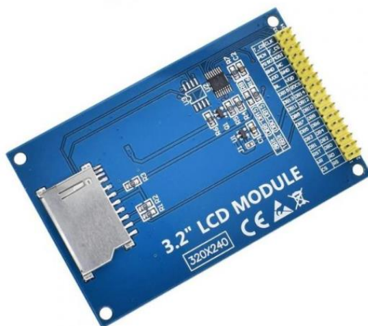
Рис. 4.6 – Розташування виводів TFT LCD на контролері ILI9341
