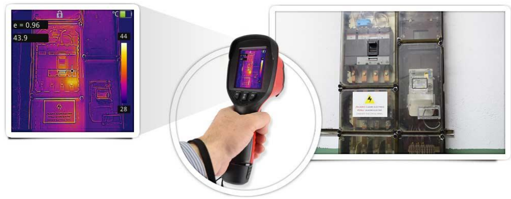
Рис. 3.1.Зображення в інфрачервоному спектрі електричної панелі, отримане за допомогою тепловізійної камери
