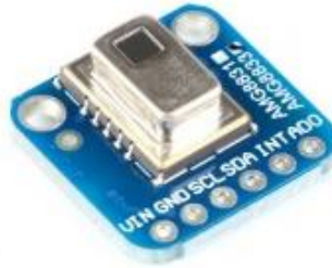
Рис.4.3 – Інфрачервоний датчик AMG8833
