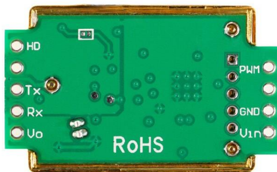
Рис.4.6. Розташування виводів датчика CO2 MH-Z19
