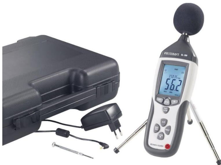
Рис. 2.7. – Професійний цифровий шумомір Voltcraft SL-451 (30-130 дБ).
