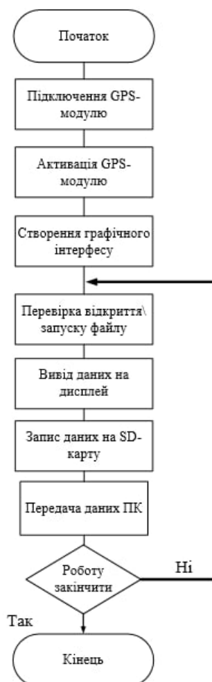
Рис. 6.2. - Блок-схема підключення GPS-модуля
