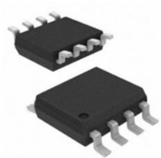
Рис. 3.9. – RTC DS1338Z-33 годинник точного часу.
