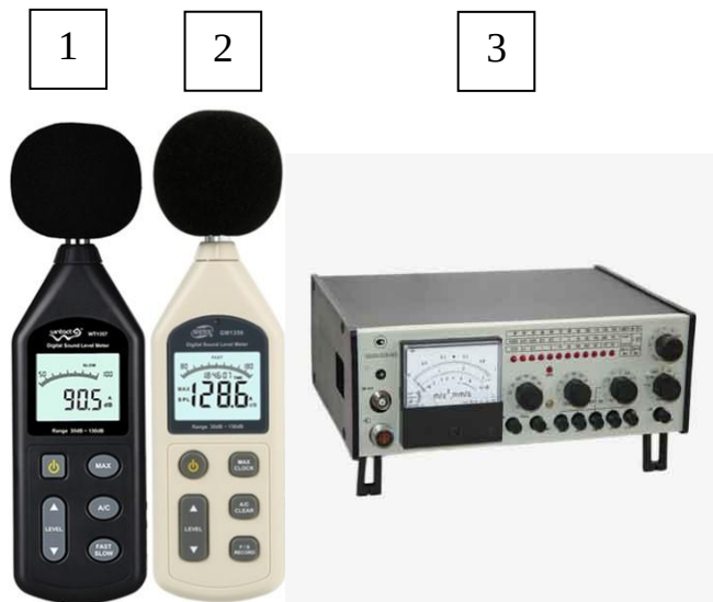
Рис. 2.1. Шумоміри: 1 - Wintact WT1357, 2 - Benetech GM1356, 3 - ВШВ-003-М2
