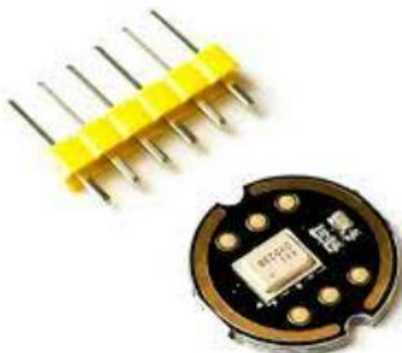
Рис. 3.5. - Зовнішній вигляд всепрямованого електронного мікрофона INMP441
