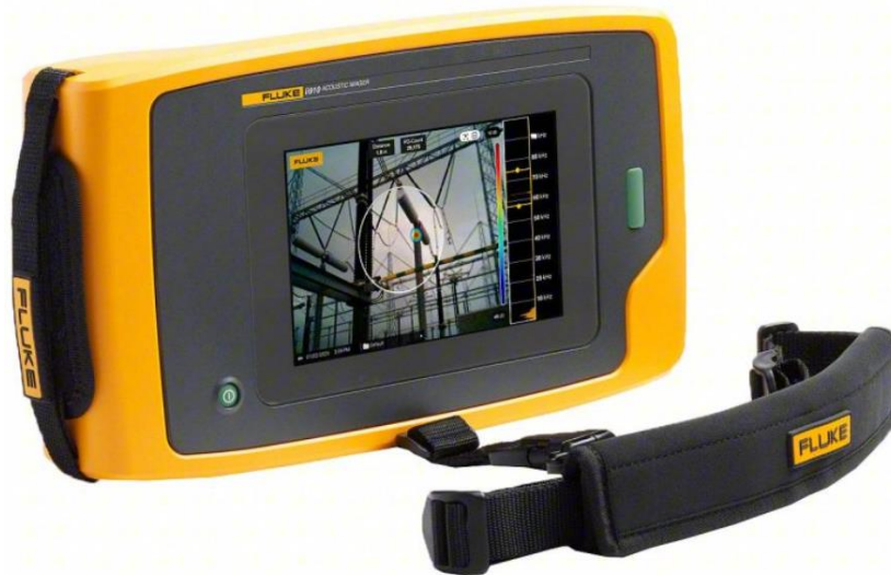
Рис. 2.3. – Акустична камера FLUKE
