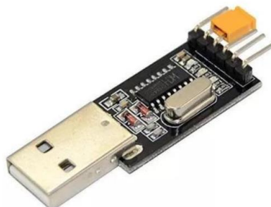
Рис. 3.7. – USB перехідник для програмування та налагодження модулю ESP32
