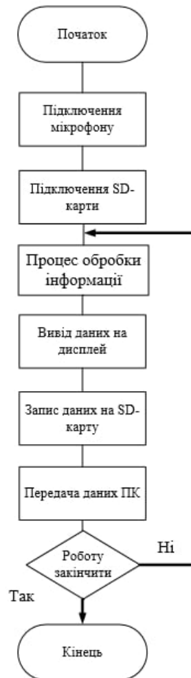
Рис. 6.3. - Блок-схема підключення мікрофона та запису акустичних даних
