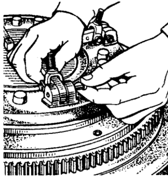
Рис. 2.3. Зняття пальця важеля вимикання зчеплення
