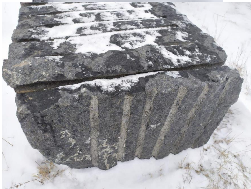
Рисунок 2.1 – Приклади блочної сировини на Невирівському родовищі
